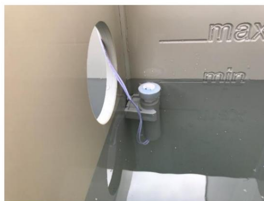
Le flotteur est en position "rinçage", la pompe du bassin est en marche. Le tambour tourne et la pompe de rinçage rince le chiffon. Si le flotteur reste dans cette position pendant 30 secondes, l'électronique passera en MODE DRY RUN.
